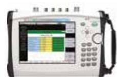
MT8220T BTS Master – лёгкий, переносной анализатор базовых станций, позволяющий выполнять в полевых условиях различные измерения, требующиеся во время монтажа, ввода в эксплуатацию и обслуживания современных сложных беспроводных сетей.
