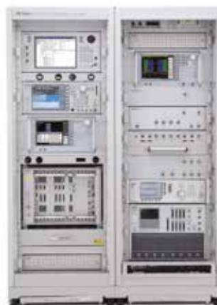
Система ME7873L предназначена для тестирования характеристик приема/передачи ВЧ сигнала, проверки требований к функционированию и RRM-функционирования мобильных терминалов LTE FDD/TDD в соответствии с требованиями 3GPP TS 36.521-1 и TS 36.521-3. LTE → GSM/UMTS/ CDMA2000/TD-SCDMA и UMTS /TD-SCDMA → LTE, Inter-RAT тесты. Также поддерживаются тесты UMTS 3GPP TS 34.121-1 Rel-7/8.
