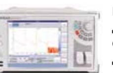
MW90010A предназначен для локализации дефектов в сверхдлинных подводных кабелях длиной до 12 000 км с множеством оптических усилителей (EDFA).
