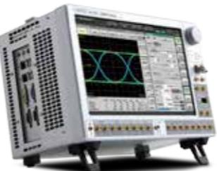
Модель BERTWave MP2100B является универсальным инструментом с интегрированным тестером коэффициента ошибок по битам и стробоскопическим осциллографом и предназначена для оценки оптических модулей, включающей измерение коэффициента ошибок по битам, тест на соответствие маски, анализ глазковой диаграммы и т.д.
